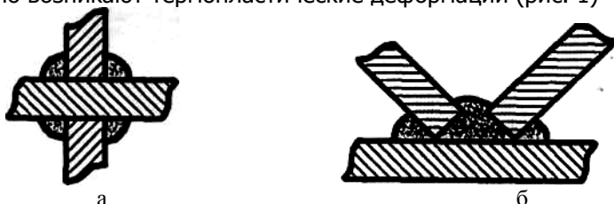
Рис. 1 Недопустимые пересечения (а) и совмещения (б) сварных швов.
