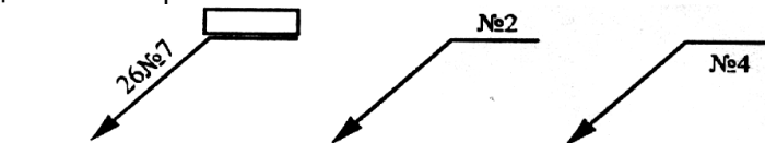
Рис. 5. Обозначение одинаковых швов
