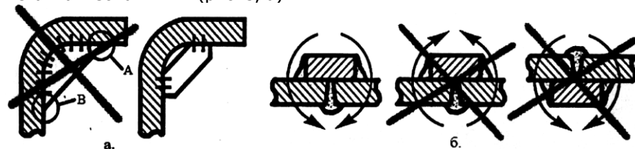
Рис. 3 Рациональные форма (а) и расположение (б) ребер и накладок.
